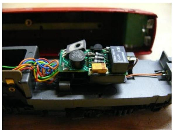
Nachdem wir also die Lok geöffnet haben und der Motor nach Anleitung umgebaut wurde geht es an die Steuerung der Lok im oberen Bild rechts sieht man gut den elektronischen Analogen Umschalter den reissen wir nun gewaltfrei aus der Lok. Lötet dazu alle Kabel ab und entnehmt den Umschalter. gleiches git natürlich auch für einen Mechanischen Umschalter oder alte Decoder.
