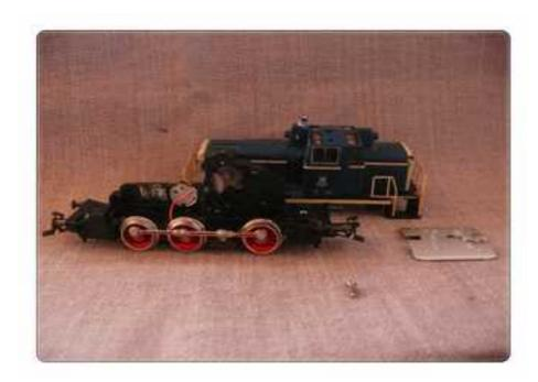
Nun wollen wir aber die Lok wieder zum fahren bringen! also schnell den Motor einbauen. Ausserdem gleich noch die Platinenhalterung einschrauben. Diese wird hier benötigt, da zu wenig Platz ist den Decoder einzustecken wenn man die Platine direkt anschraubt. Bei mir sieht das dann ungefähr so aus.....
