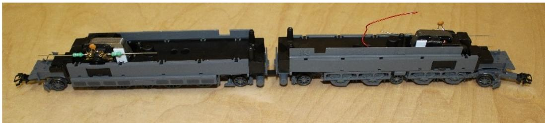
gegebenenfalls die neuen Motoren einbauen. hier kann man dann auch gleich die grünen und blauen Motorkabel an die Drosseln löten. !Achtung! Die Blauen jeweils rechts und die grünen links. beim Anlöten bitte die Lok nicht drehen. Sonst stimmt die Kabel Anordnung nicht und die Motoren laufen gegeneinander.
