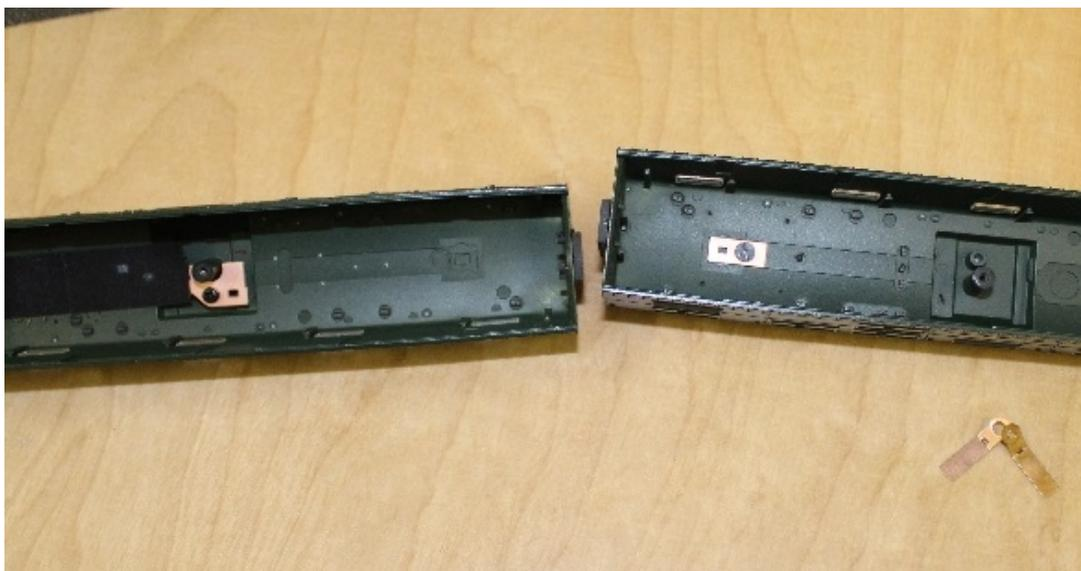
Als nächstes entfernen wir den Umlauf und die Führerstandeinrichtung und Kleben die FSB ein.
